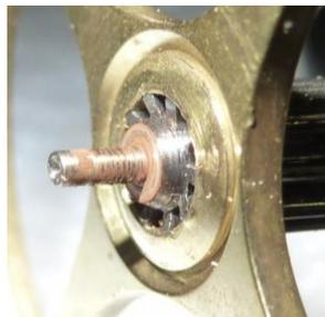
Figure 3: Usure de pivot après fonctionnement
