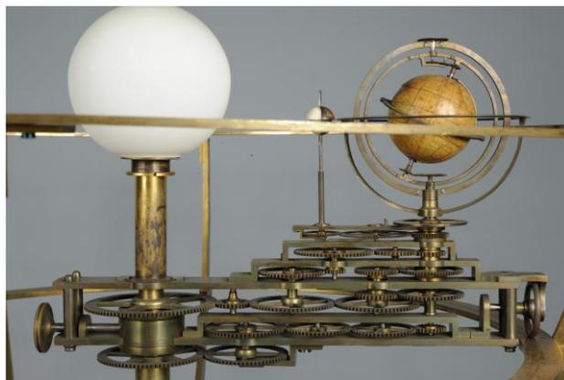
Figure 1: Vue partielle du mécanisme du Tellurium
