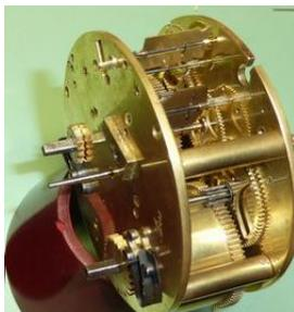
Figure 2: Mécanisme horloger dit "mouvement de Paris"
